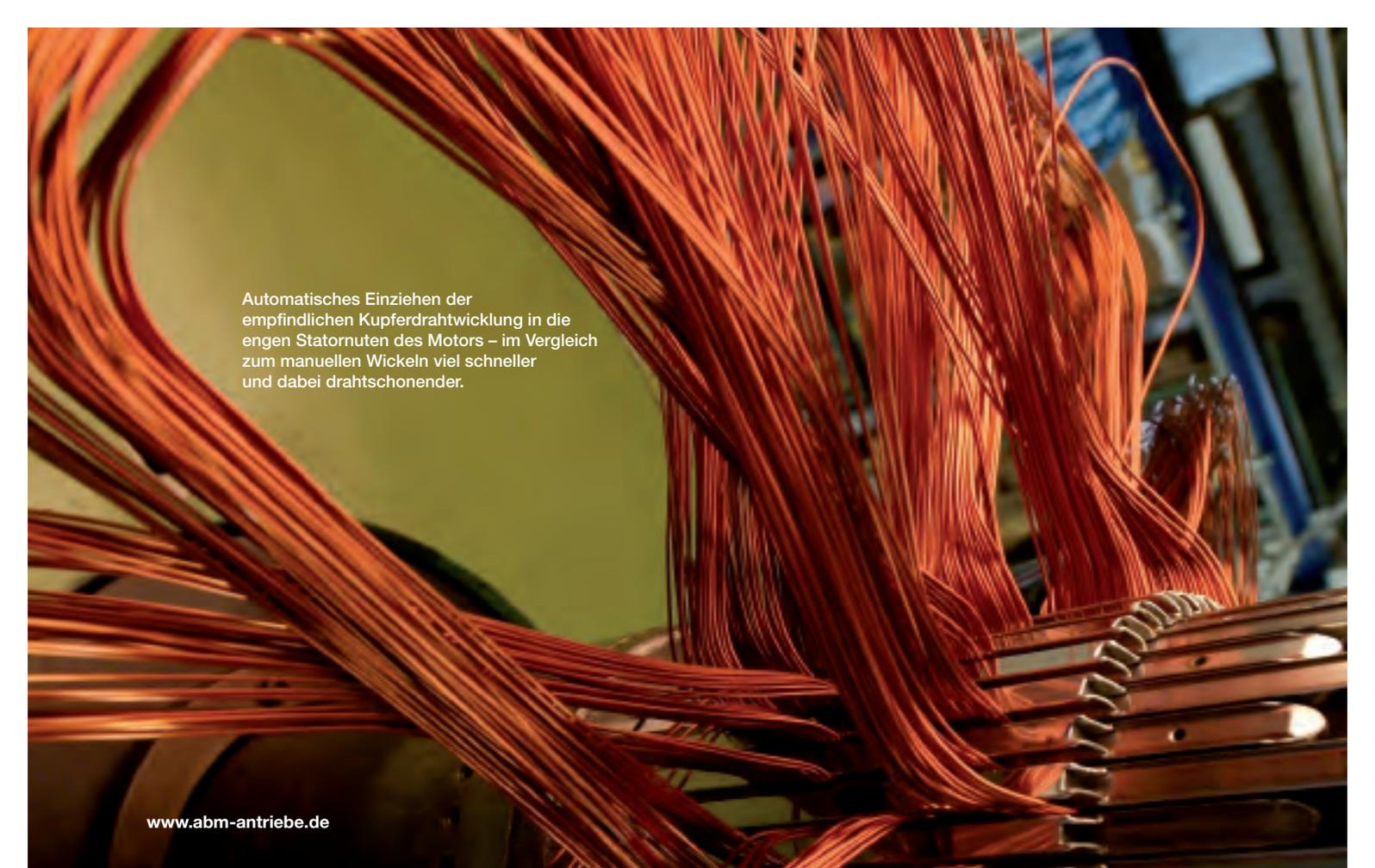
Automatisches Einziehen der empfindlichen Kupferdrahtwicklung in die engen Statornuten des Motors – im Vergleich zum manuellen Wickeln viel schneller und dabei drahtschonender.
