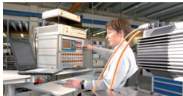
Die Parameter der SINOCHRON® Motoren werden auf programmgesteuerten Prüfständen ermittelt.
